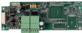
**PREVIDIA-C-COM** disponibiliza duas portas RS232 e duas portas RS485 para conexão de comunicadores remotos, utilizando os protocolos disponíveis na tabela.
